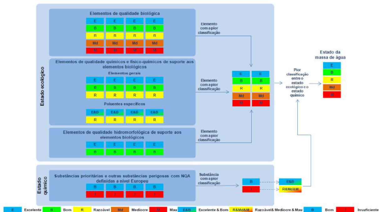
Figura 8. Representação esquemática da classificação do estado das massas de água superficiais Fonte: Planos de Gestão de Região Hidrográfica, disponíveis em http://www.apambiente.pt/ (consultado em Abril de 2013)
