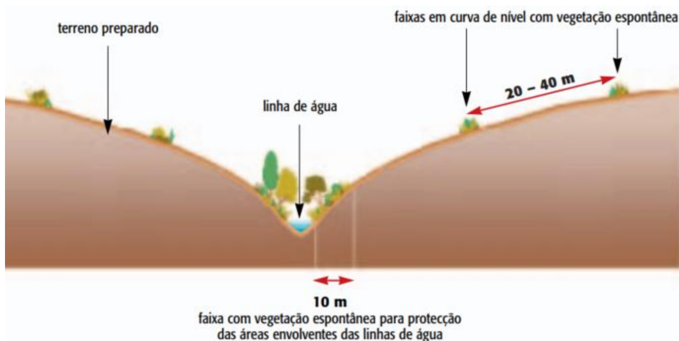
Figura 3: Preparação do terreno com manutenção das faixas de protecção contra erosão nas encostas e nas áreas envolventes das linhas e água. Fonte: DSVPF (2003)
